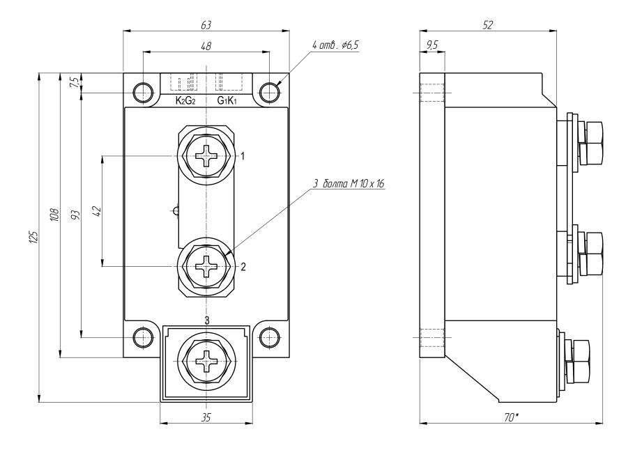
\*Габаритный чертеж корпуса для ТТР серии:
